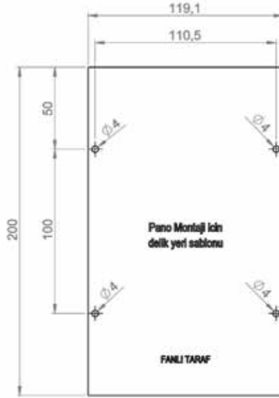
Şekil 7: Statik Kontaktör Mekanik Bağlantı Şablonu
